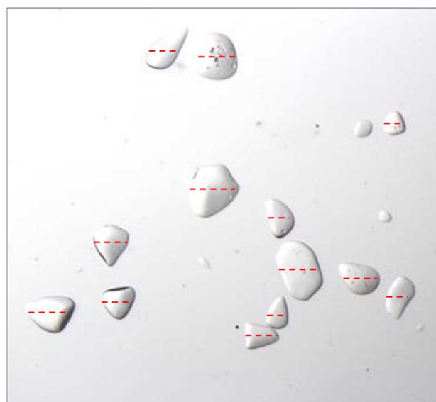
図 2.1.3 マーチン径の採寸例
